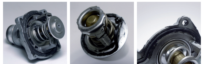
Abbildung 1: Thermostate mit zusätzlicher Dichtmasse
