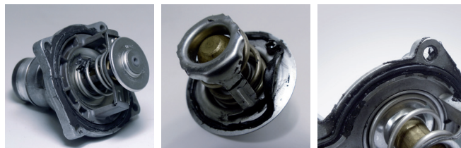
Zdjęcie 1: Termostaty z dodatkową masą uszczelniającą
