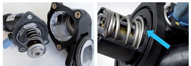
Figura 2: Los sellantes, los cuerpos extraños y los residuos provocan averías y bloqueos en el termostato
