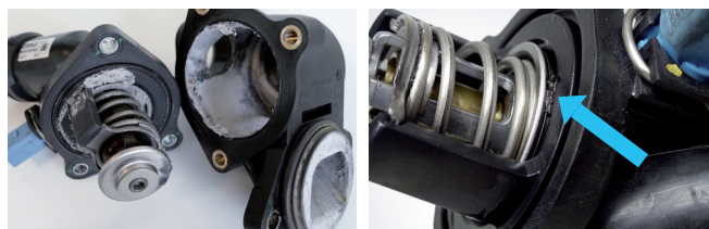
Zdjęcie 2: Środek uszczelniający, ciała obce i inne pozostałości powodują nieprawidłowe działanie i blokowanie termostatu
