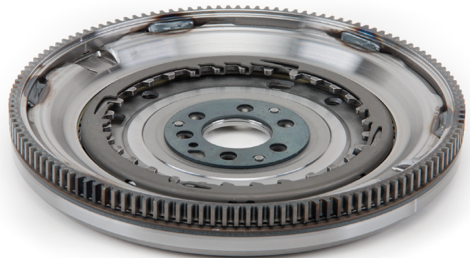
Bild 1: Die Zähnezahl am Starterkranz des Neuteils muss identisch zum Altteil sein
