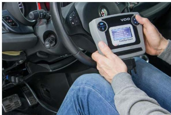
Grundeinstellung mit einem geeigneten Diagnosegerät
