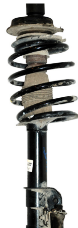
Korrekt montierte Kopfplatte
