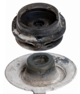
Korrekt ausgerichtete Kopfplatte & Lagerung
