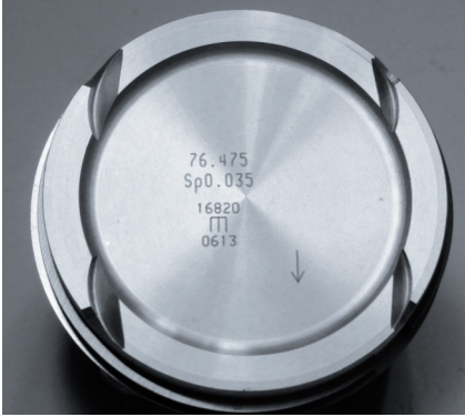
Resim 1: Piston kafası üzerindeki bilgiler – Çap, montaj boşluğu ve montaj yönü (ok)
