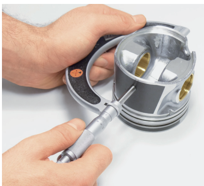
Рисунок 2: Измерение диаметра выполняется на юбке под прямым углом к пальцу
