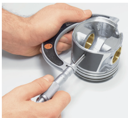
Rys. 2. Średnicę mierzy się prostopadle do osi sworznia tłokowego, na dolnej stronie płaszczu
