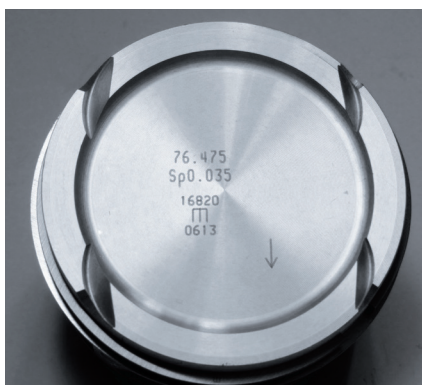
Rys. 1. Parametry umieszczone na denku tłoka: średnica, luz montażowy i kierunek montażu (strzałka)
