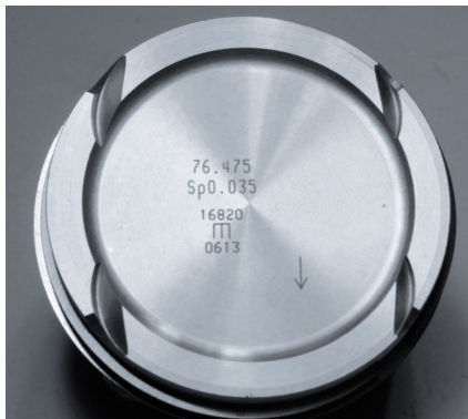
Abbildung 1: Angaben auf dem Kolbenboden – Durchmesser, Einbauspiel und Einbaurichtung (Pfeil)
