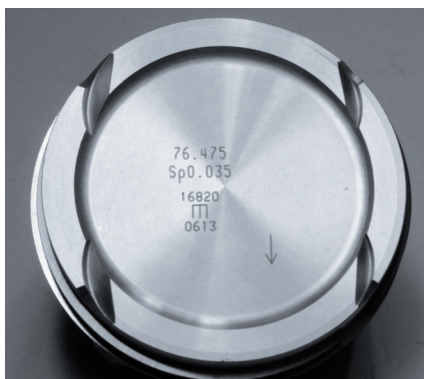
Figure 1 : Indications sur la tête de piston : diamètre, jeu de montage et sens de montage (flèche)
