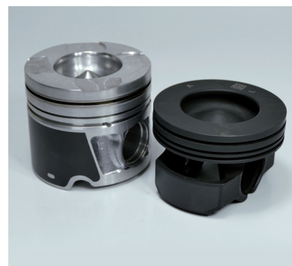
Rys. 3. Tłok aluminiowy i tłok stalowy z powłoką grafitową na płaszczu
