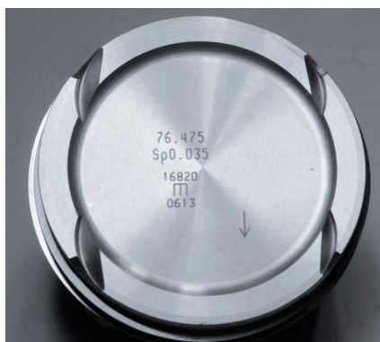
Figura 1: Datos en la cabeza del pistón: diámetro, holgura de montaje y dirección de montaje (flecha)
