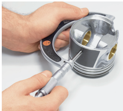
Εικόνα 2: Η διάμετρος μετρείται στον άξονα, κάθετα προς τον άξονα του μπουλονιού
