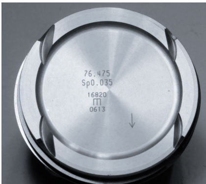
Εικόνα 1: Στοιχεία επάνω στην κεφαλή του εμβόλου – Διάμετρος, ανοχή συναρμολόγησης και φορά συναρμολόγησης (βέλος)
