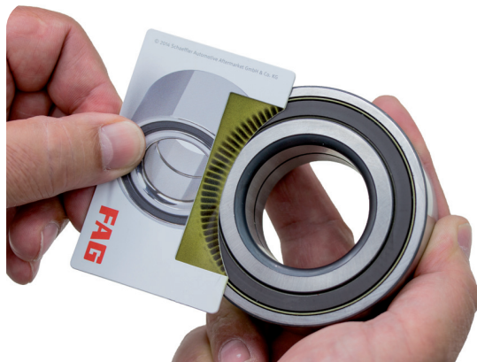
Bild 1: Mit der Encoderkarte kann die Einbauseite eines Multipol-Encoders festgestellt werden. Bei passiven Encoder funktioniert dies nicht
