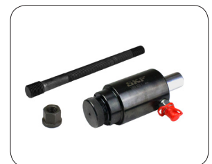
VKN 602-1 optionaler Hydraulikzylinder
