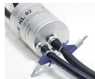
Рисунок 3: Перекрытие трубопроводов зажимами помогает предотвратить попадание воздуха в топливную систему
