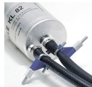
Figure 3 : Pincer les conduites permet d'éviter la pénétration d'air dans le système à carburant.
