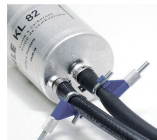
Εικόνα 3: Η αποσύνδεση των γραμμών αποτρέπει την εισχώρηση αέρα στο σύστημα καυσίμου
