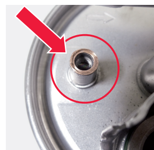
Rysunek 2: Uszczelka śruby odwadniającej przy filtrze oleju napędowego KL 154
