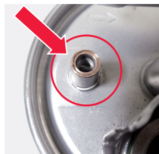
Figure 2 : Joint de la vis de drainage au niveau du filtre à carburant diesel KL 154.
