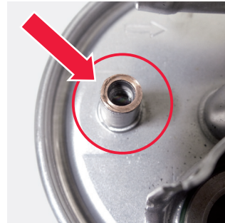
Resim 2: Dizel yakıt filtresi KL 154'teki hava tahliye vidasının contası
