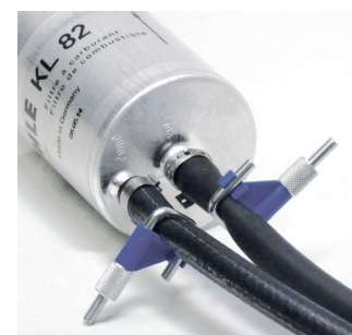
Rysunek 3: Odlączenie przewodów zapobiega wnikaniu powietrza do układu paliwowego
