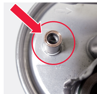
Abbildung 2: Dichtung der Entwässerungsschraube am Dieseldieselkraftstofffilter KL 154
