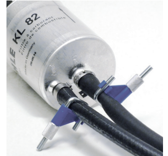
Resim 3: Hatların sökülmesi, havanın yakıt sistemine girmesini önler
