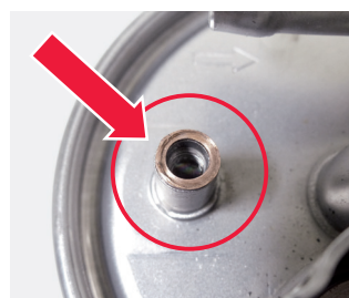
Рисунок 2: Прокладка спускной пробки фильтра дизельного топлива KL 154
