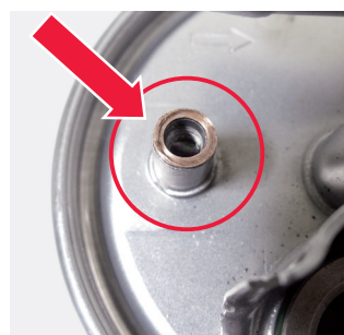
Figura 2: Junta del tornillo de desagüe en el filtro de combustible KL 154
