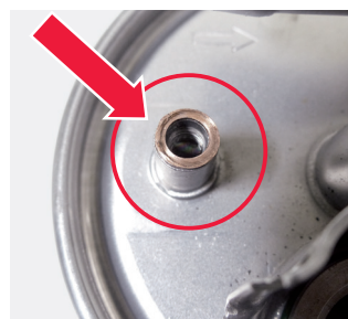
Εικόνα 2: Φλάντζα της βίδας αποστράγγισης στο φίλτρο καυσίμου ντίζελ KL 154
