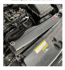
Zwei Befestigungsschrauben des Ladeluftführungsrohrs abschrauben. Elektrische Steckverbindung des Ladedrucksensors trennen. Das gesamte Ladeluftführungsrohr nach unten herausziehen.
