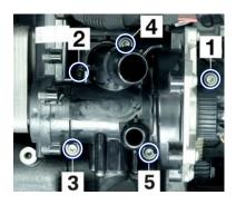
Dichtungsflächen am Zylinderblock gründlich reinigen. Es wird dringend empfohlen, neue O-Ringe für das Verbindungsrohr zu verwenden. Neue O-Ringe nur mit Kühlflüssigkeit befeuchten. Verbindungsrohr in die Öffnung des Motorölkühlers einbauen. Kühlmittelpumpe mit Thermomanagement-Modul auf das Verbindungsrohr und die Zentrierstifte im Zylinderblock schieben.
