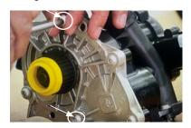
5 Schrauben der Thermomanagement-Einheit mit einem Drehmoment von 9 Nm anziehen.
