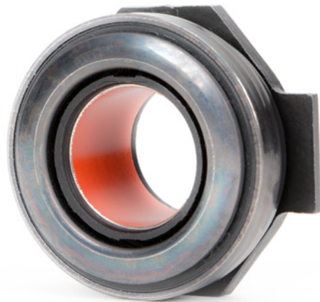
Bild 3: Ausrücklager mit PTFE-Buchsen dürfen nicht mit Schmierstoff versehen werden
