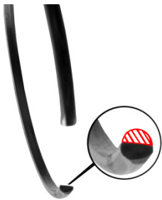
Abb. 3: Sicherungsring verschlissen. Folge: Ausrücker löst sich von der Membranfeder → schlagartiger Kraftschluss
