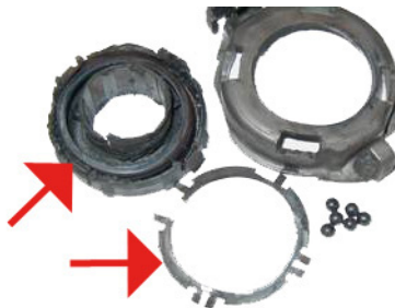
Abb. 4: Mechanische Schäden und Überhitzung am Ausrücker
