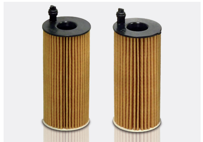
Рис. 1: Внешне практически одинаковые картриджи масляных фильтров: OX404 (слева) и OX813/1 (справа)
