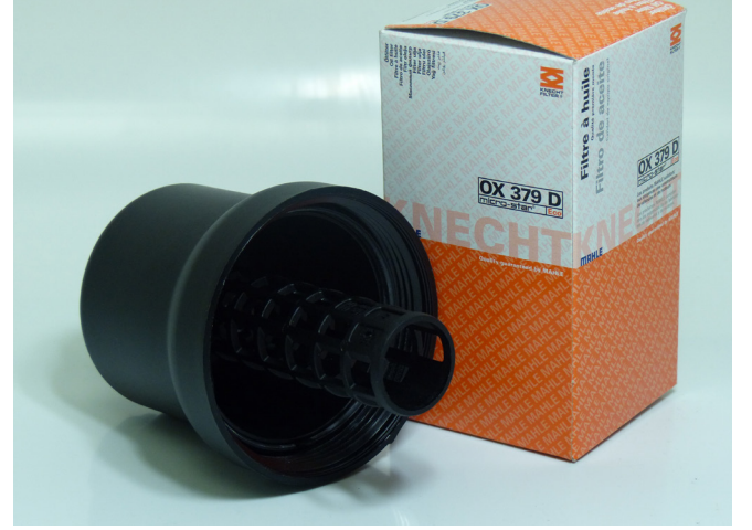
Resim 1: Gövde kapağı sökülmüş yağ filtresi elemanı
