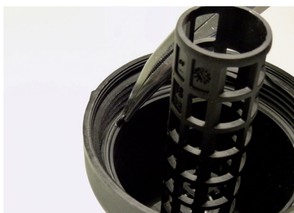
Рисунок 2: Язычок помогает удалить старую прокладку
