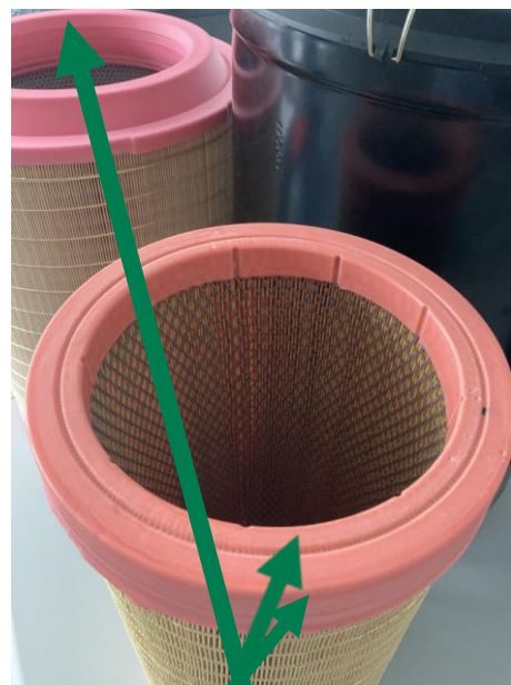
Deckel von Sekundärelement und Innenseite des Deckels Hauptelement sollen eingefettet werden
