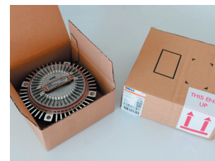
Zdjęcie 2: Prawidłowa pozycja przechowywania bimetalicznego sprzęgła Visco® (zgodnie z instrukcją na opakowaniu z paskiem bimetalicznym skierowanym do góry)
