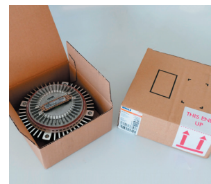
Иллюстрация 2: Правильное положение биметаллической муфты Visco® при хранении (в соответствии с маркировкой на упаковке — биметаллическая полоска находится сверху)
