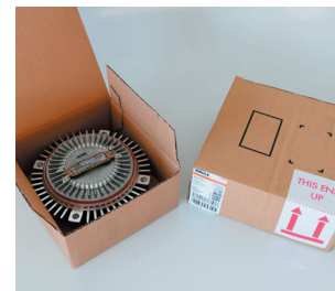
Abbildung 2: Korrekte Lagerposition einer Bimetall-Visco®-Kupplung (entsprechend der Verpackungsbeschriftung mit dem Bimetall-Streifen nach oben zeigend)
