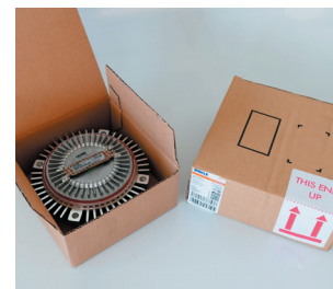
Figure 2 : Position de stockage correcte d'un Visco®-coupleur bimétallique (avec les bandes bimétalliques vers le haut, conformément à l'indication sur l'emballage)
