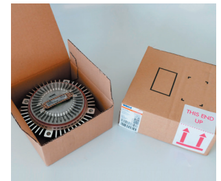
Εικόνα 2: Σωστή θέση αποθήκευσης ενός διμεταλλικού συμπλέκτη Visco® (σύμφωνα με την ετικέτα συσκευασίας με τη διμεταλλική ταινία να δείχνει προς τα επάνω)
