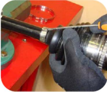
2. Die Antriebswelle in einen Schraubstock spannen (mit Aluminiumbacken oder gepolsterten Backen) Beide Schellen entfernen und anschließend Manschette auftrennen und entsorgen.
