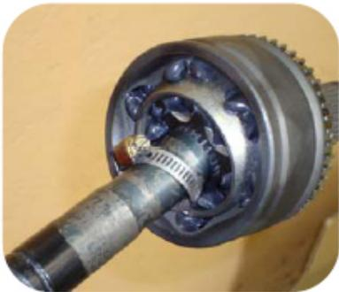
3. Das neue Gleichlaufgelenk mit einem Kunststoffhammer auf die Welle treiben - bis der Sicherungsring in der Nut des Gleichlaufgelenkes einrastet. Schlauchschelle entfernen.
