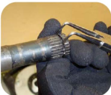
6. Sicherungsring mit einer Spezialzange spreizen und entfernen.
