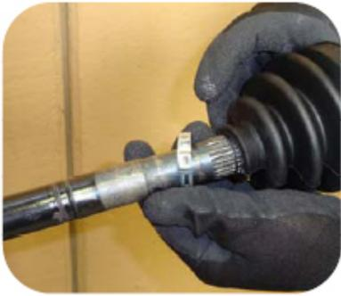
1. Die kurze Schelle auf die Welle setzen, danach die Manschette auf die Welle schieben.
