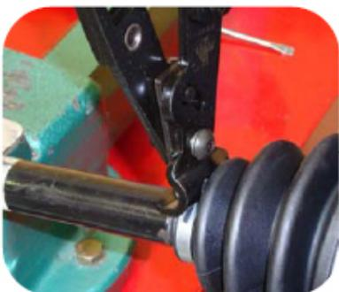
5. Die Schellen auf die Manschette setzen und mit der Spezialzange für Universalschellen anziehen.
