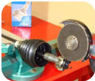
4. Innenlaufring an den Kugelprofilen an mehreren Stellen mit einem entsprechenden Schneidewerkzeug durchtrennen.
