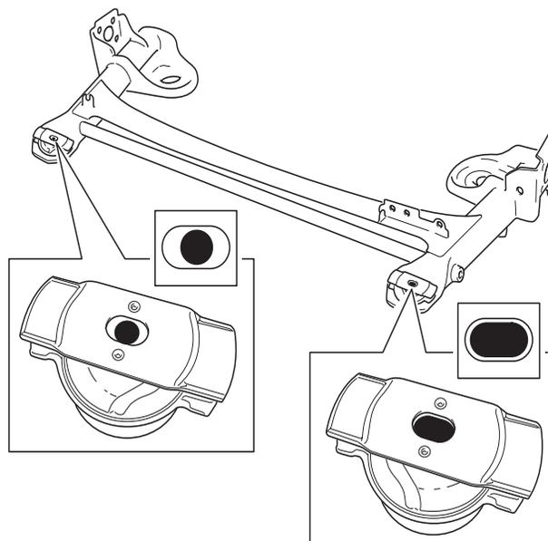
Bild 1: Richtige Orientierung der Lagerungen in der Hinterachse
