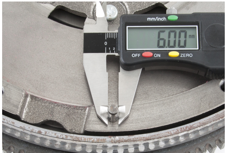
Bild 1: Durchmesser der Zentrierstifte ermitteln
