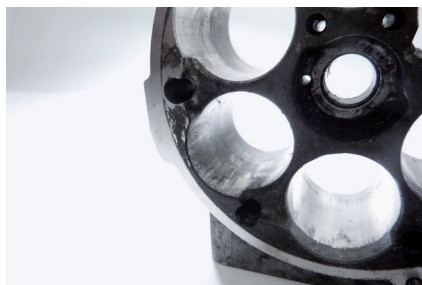
Εικόνα 1: Φθορά εμβόλου στον συμπιεστή κλιματιστικού εξαιτίας υπερβολικού σκιαγραφικού μέσου
