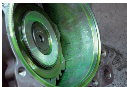
Abbildung 2: Überdosiertes Kontrastmittel im Kompressoröl
