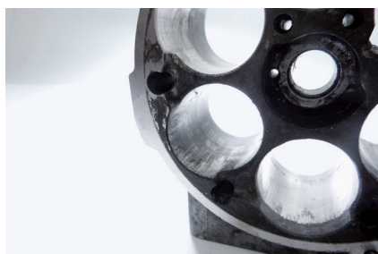
Иллюстрация 1: Коррозия цилиндров на компрессоре кондиционера из-за слишком большого количества контрастного вещества
