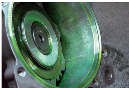
Εικόνα 2: Υπερδοσολογία σκιαγραφικού μέσου στο λάδι συμπιεστή
