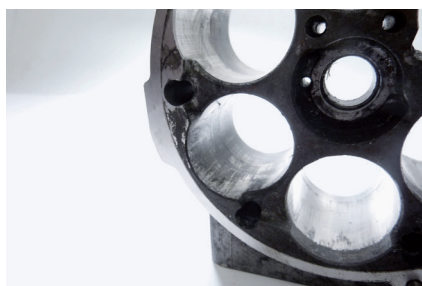
Figure 1 : Piston grippé sur le compresseur de climatisation en raison d'une quantité trop élevée de traceur
