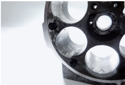
Resim 1: Çok fazla kontrast madde nedeniyle klima kompresöründe piston aşınması
