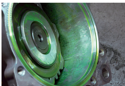
Figure 2 : Surdosage de traceur dans l'huile pour compresseur
