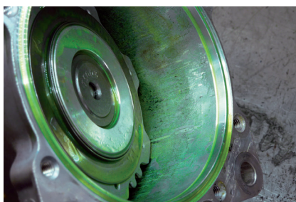
Иллюстрация 2: Излишки контрастного вещества в компрессорном масле
