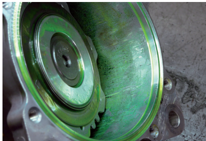
Resim 2: Kompresör yağında aşırı dozda kontrast madde
