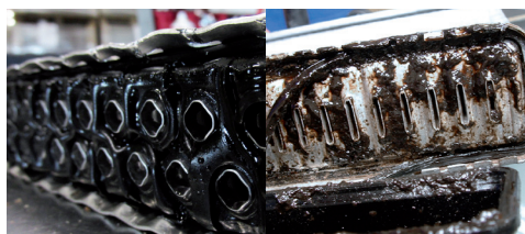
Figura 1: Juntas de goma destruidas por el aceite
