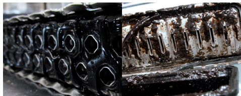
Иллюстрация 1: Разложение резиновых прокладок под действием масла
