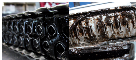
Figure 1 : Joints en caoutchouc décomposés par l'huile
