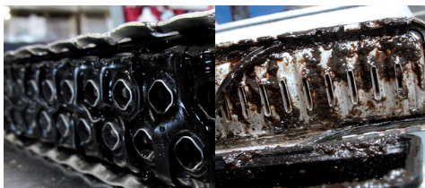
Εικόνα 1: Πλαστικές φλάντζες αποσυντεθειμένες από λάδι
