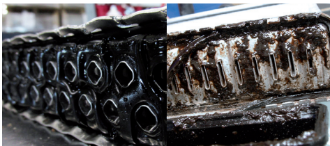
Abbildung 1: Durch Öl zersetzte Gummidichtungen
