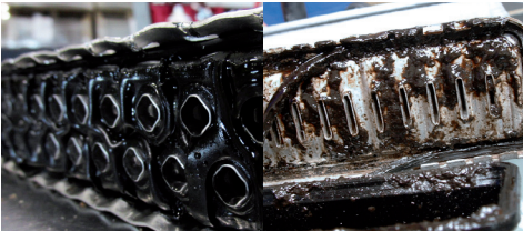
Resim 1: Yağdan dolayı parçalanmış kauçuk contalar
