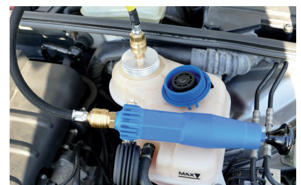
Figura 2: La válvula de la tapa también se puede comprobar aplicando aire comprimido con unos adaptadores especiales.
