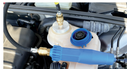
Иллюстрация 2: С помощью специальных адаптеров можно выполнить опрессовку и контроль смонтированного в крышке клапана.
