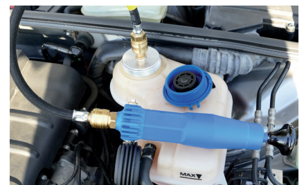
Εικόνα 2: Με ειδικούς προσαρμογείς, η βαλβίδα στο καπάκι μπορεί επίσης να εκπιεστεί και να ελεγχθεί.
