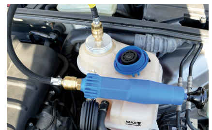
Abbildung 2: Mit speziellen Adaptern kann auch das Ventil im Deckel abgesaugt und geprüft werden.
