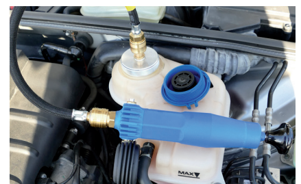
Figure 2 : Des adaptateurs spéciaux permettent également de comprimer et de contrôler la vanne dans le couvercle.
