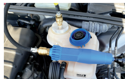
Zdjęcie 2: Specjalne adaptory umożliwiają przeprowadzenie próby ciśnieniowej zaworu w korku.
