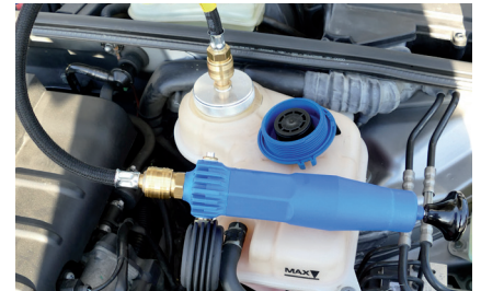
Resim 2: Özel adaptörler yardımıyla kapaktaki valf de bastırılabilir ve kontrol edilebilir.
