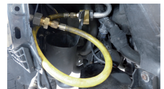
Figura 2: Los filtros deshidratadores/acumuladores deben puentearse y sustituirse para el lavado
