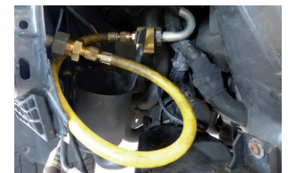
Abbildung 2: Filter-Trockner/Akkumulatoren müssen zum Spülen überbrückt und ersetzt werden
