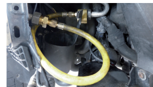
Zdjęcie 2: Na czas płukania filtry-osuszacze /zasobniki należy ominąć i zastąpić
