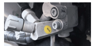
Εικόνα 3: Οι εκτονωτικές ή στραγγαλιστικές βαλβίδες πρέπει να αφαιρεθούν και να αντικατασταθούν με προσαρμογείς έκπλυσης
