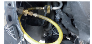
Εικόνα 2: Οι ξηραντήρες φίλτρου/συσσωρευτές πρέπει να γεφυρωθούν και να αντικατασταθούν για την έκπλυση
