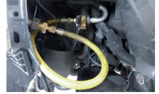
Resim 2: Filtre-kurutucu/akümülatörler, yıkama için köprülenmeli ve değiştirilmelidir
