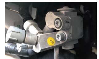
Abbildung 3: Expansions- oder Drosselventile müssen ausgebaut und durch Spüladapter ersetzt werden
