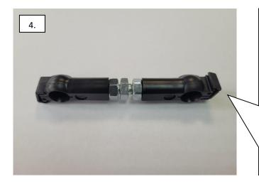
Eibach Regelstangen an beiden Seiten entriegeln und Kugelköpfe entnehmen.
