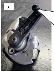
Achtung: Bruch- und Beschädigungsgefahr des Drehwinkelsensors und der Befestigungspunkte!
