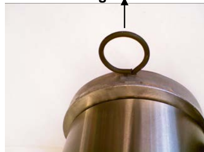
Abb. 3 Variante 2 - Stift nach Riemenmontage ausziehen
