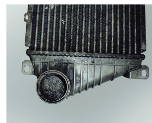
Figure 2 : Présence de copeaux provenant de la roue de compresseur dans le refroidisseur d'air de suralimentation
