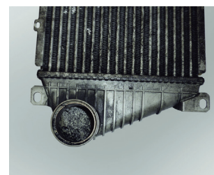
Иллюстрация 2: Осколки разрушенного колеса нагнетателя в интеркулере
