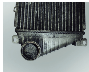
Zdjęcie 2: Wióry pochodzące ze zniszczonego wirnika sprężarki w chłodnicy powietrza doładowującego
