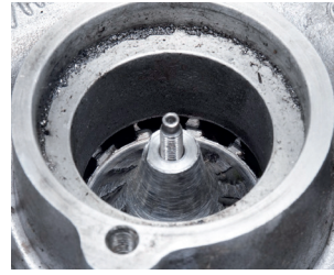
Resim 1: Yabancı maddeler nedeniyle tamamen hasar görmüş kompresör çarkı
