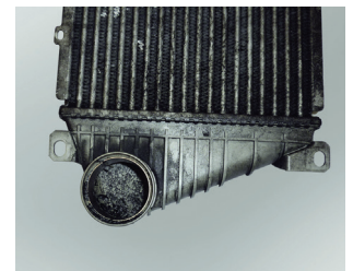
Εικόνα 2: Ρινίσματα από τον κατεστραμμένο τροχό συμπιεστή στον ψύκτη αέρα τροφοδοσίας
