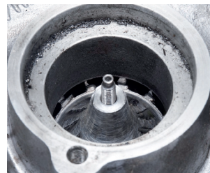
Εικόνα 1: Τροχός συμπιεστή που έχει καταστραφεί εντελώς από ξένα σωματίδια
