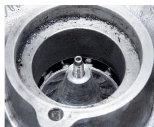
Иллюстрация 1: Полностью разрушенное посторонними частицами колесо нагнетателя
