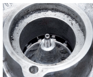
Figure 1 : Roue de compresseur complètement détruite par des corps étrangers
