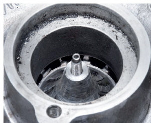
Zdjęcie 1: Wirnik sprężarki całkowicie zniszczony przez ciała obce
