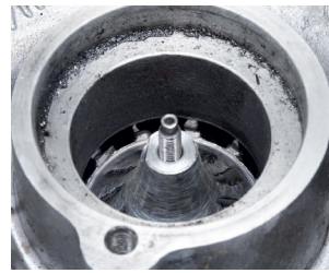
Figura 1: Rueda del compresor completamente destruida por cuerpos extraños
