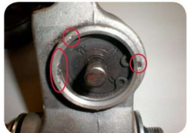
Bild 7: Dellen am Spannergehäuse
