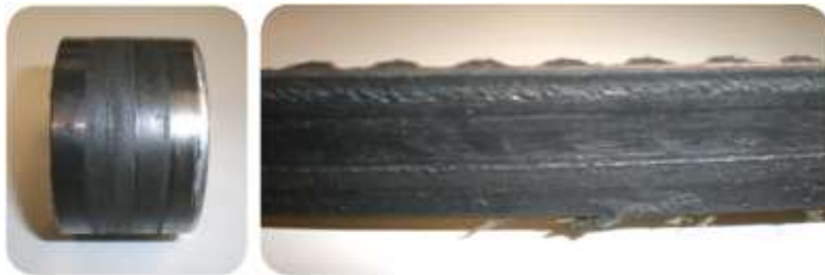
Abbildung 12: Schadensbild bei Überhitzung
