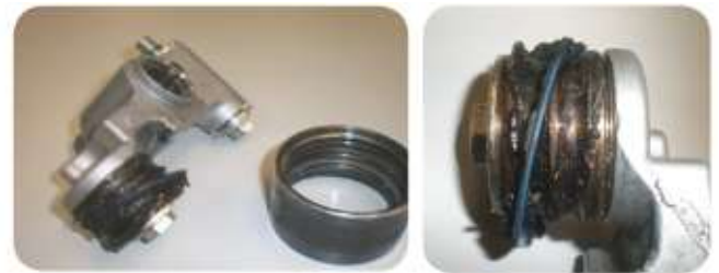
Bild 13: Vorzeitiges Festfressen der Lager
