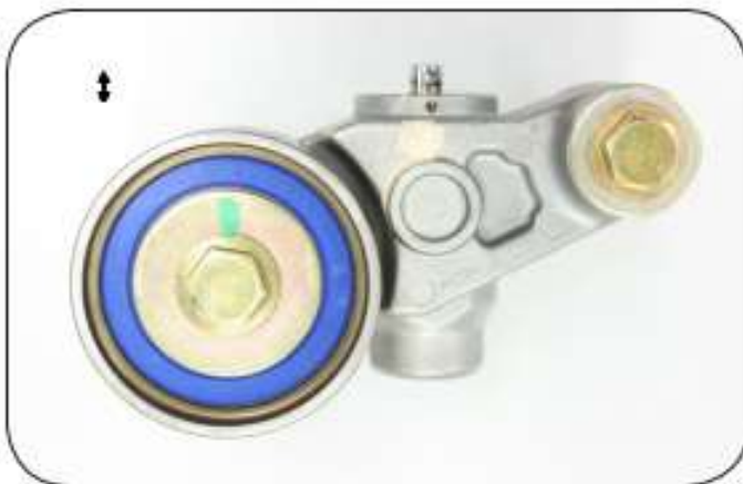
Abbildung 6: Wenn der Kolben nicht innerhalb +/- 0,5 mm von 5,7 mm – ist, den Spanner austauschen
