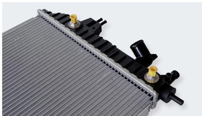
Εικόνα 2: Πώματα επάνω στις συνδέσεις του ψυγείου λαδιού
