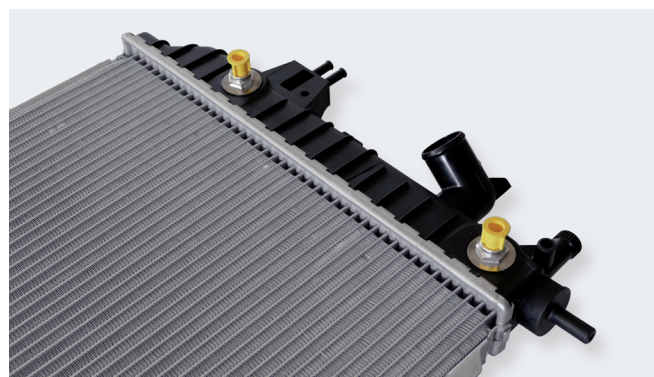
Figure 2 : Bouchon d'obturation sur les raccords du refroidisseur d'huile
