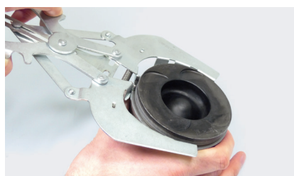
Abbildung 2: Ringe mit geeigneter Kolbenringzange montieren.
