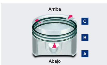
Figura 1: Respetar el orden de montaje (A, B, C) y girar los cortes de segmento 120° entre sí.
