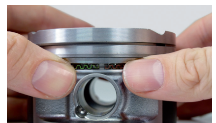
Figura 3: Deben estar visibles ambas marcas de color de las laminillas.
