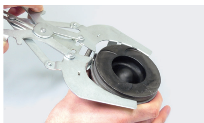
Figura 2: Montar los segmentos con unas tenazas para segmentos de pistón adecuadas.
