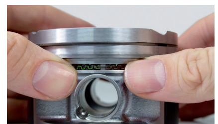
Abbildung 3: Beide Farbmarkierungen der Lamellen müssen sichtbar sein.
