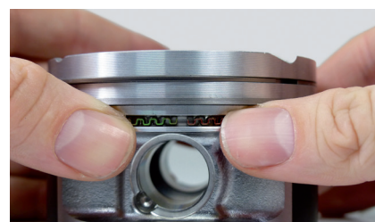
Figure 3 : Les deux marquages couleur des lamelles doivent être visibles.
