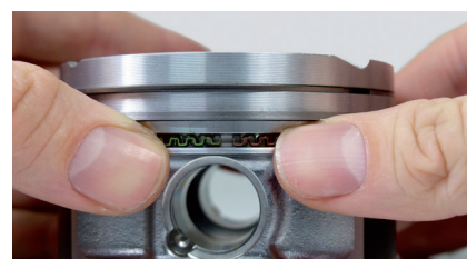
Ilustracja 3: Oba barwne oznaczenia lamel muszą być widoczne.
