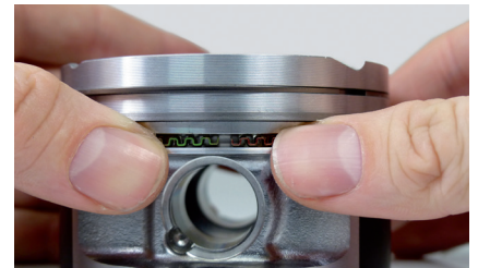
Resim 3: Lamellerin her iki renkli işaretlemesi de görünür olmalıdır.
