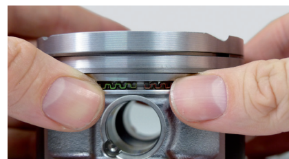
Иллюстрация 3: Обе цветные маркировки на пластинах должны оставаться видимыми.
