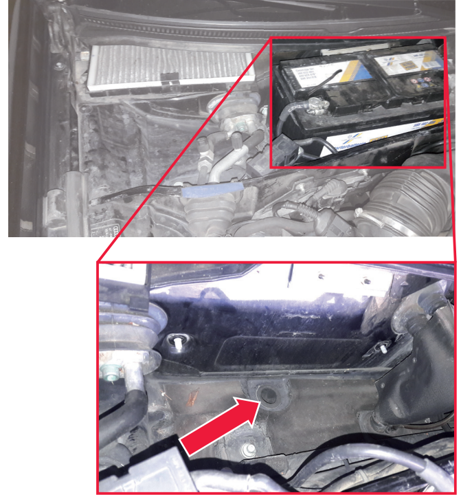
Resim 2: Yağmur suyu kanalında akünün altındaki su tahliyesi (ok)
