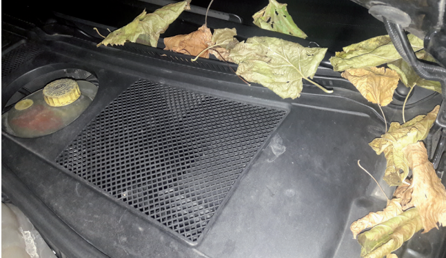
Resim 1: Yağmur suyu kanalında ağaç yaprakları
