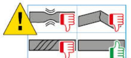
DE Leitung nicht beschädigen. | EN Do not damage the line. | ES No dañe el conducto. | FR Ne pas endommager la conduite. | EL Να μην προκαλείτε βλάβη σε αγωγούς και καλώδια. | ID Jangan merusak kabelnya. | JA 配線を破損しないようご注ください。 | MS Jangan rosakkan kabel. | PT Não danificar o cabo. | PL Nie uszkodzić przewodu. | ZH 不得损坏管线。 | KO 케이블을 손상시키지 마십시오. | RU Не повредить кабель. | TH ไม่ทำลายสายไฟชาร์จเดิมหาย | TR Kabloya hasar verilmemelidir. | UK Уникати пошкодження проводів. | AR عدم إذالت التوصيل
