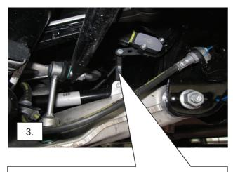
Eibach Regelstangen auf die Länge der Serien-Regelstangen einstellen, montieren und mit den serienmäßigen Muttern verschrauben.
