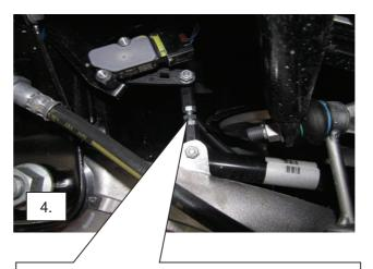
Fahrzeug gegen Wegrollen sichern und Motor starten. Eibach Regelstange über die Einstellschraube, soweit zusammendrehen (1 Umdrehung ca. 8mm) bis der Höhenstand It. Teilegutachten, siehe Seite 19, Punkt IV.7 und 8 erreicht wird. Beide Seiten der Eibach Regelstange kontern.
